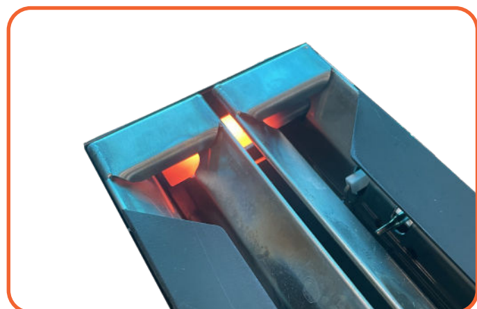
Afb. 4.5 PRIMING: brandstof wordt ontstoken
