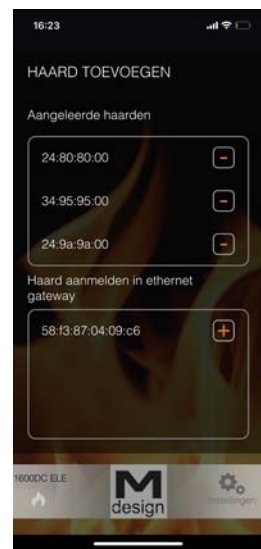
3. Druk op de '+' naast het IP adres van de gateway. De haard werd toegevoegd. Druk daarna rechtsboven op het vlammetje
