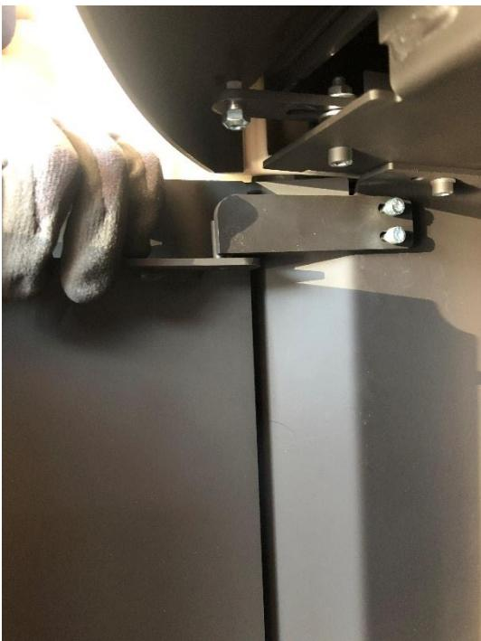
Führen Sie nun den Pin des Halters für die Tür von oben in das dafür vorgesehene Loch an der Tür ein, richten Sie die Tür aus und ziehen Sie die Schrauben des Türhalters fest.
