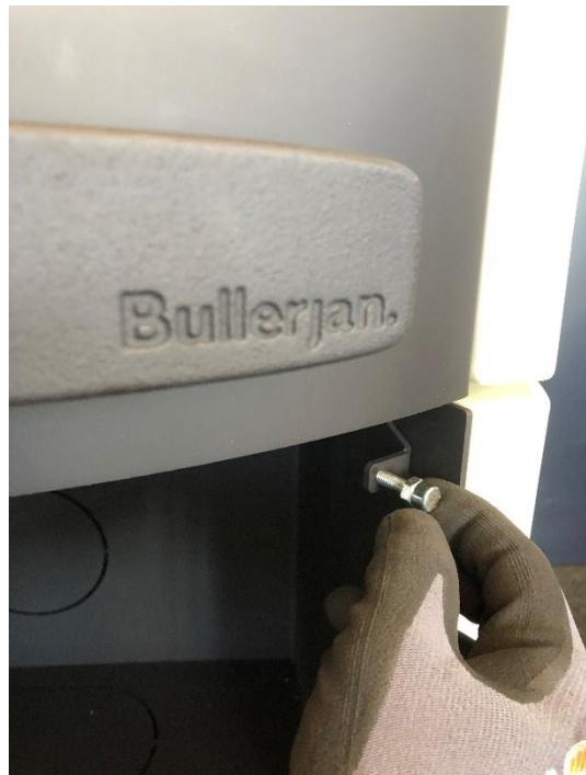
Drehen Sie die Schraube mit Magnetkopf inklusive der aufgeschraubten Mutter in die soeben montierte Halterung ein.
