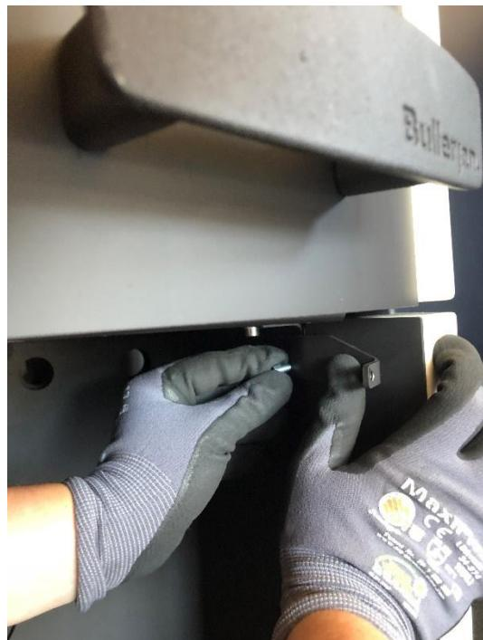
Befestigen Sie den Halter für den Magnetanschlag an der rechten Innenseite der Holzbox.
